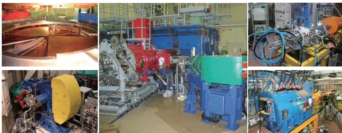
図1. (中央) 930型サイクロトロン、(左上) サイクロトロン加速電極、(左下) 中性子ビームライン、(右上) 大強度負イオン源、(右下) 重イオン源。
