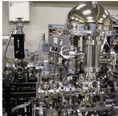
図1. 東北大学に建設した世界最高水準のエネルギー分解能を有する ARPES 装置
