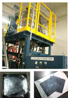
キャスト成長装置と Si 多結晶インゴット
