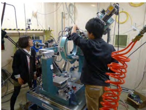
図1. KEK PF BL-4C の四軸回折計。
