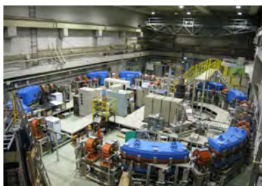
1.3 GeV 電子シンクロトロン（BST リング）
