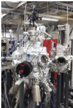
ハライドの高品質薄膜作製に最適化した MBE 装置
