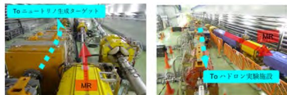
図3. 主リングシンクロトロン（MR）のビーム取り出し部の写真。
