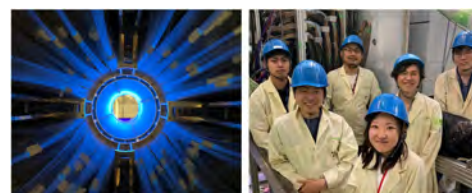
図2. 我々が開発し J-PARC でのハイペロン・陽子散乱実験に用いた円筒型ファイバー検出器 (左) と、実験メンバー (右)。
