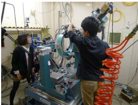
図1. KEK PF BL-4C の四軸回折計。
