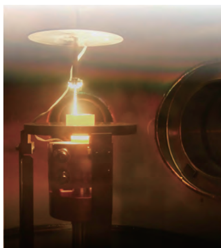
図1. タングステン坩堝の電子ビーム溶接。高蒸気圧・高融点化合物の単結晶育成を可能にする。
