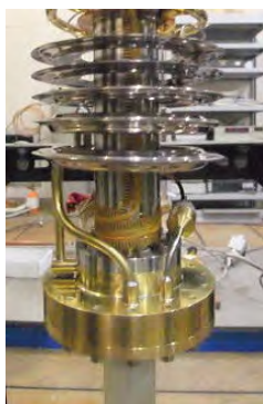
図１：新物質開発用テトラーク炉. 純良結晶の育成に用いられます。
