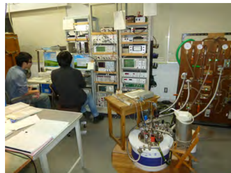
図2：14T 超伝導マグネット(手前床下)と NMR スペクトロメーター
