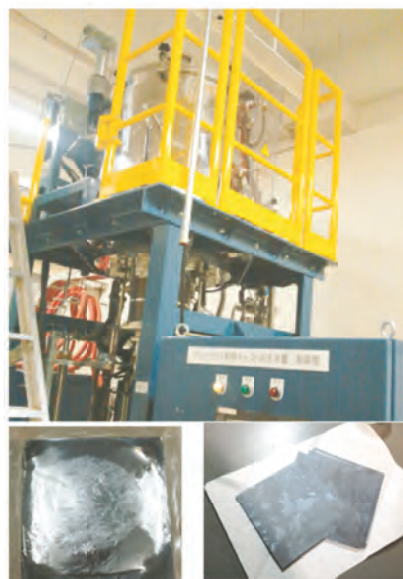
キャスト成長装置と太陽電池用 Si 多結晶インゴット
