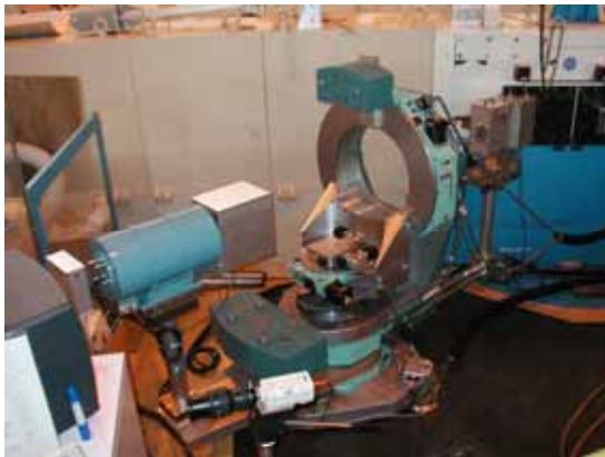
単結晶四軸回折装置 FONDER (物性研所有: 多元研グループが管理) 有機物など複雑な構造での構造解析
