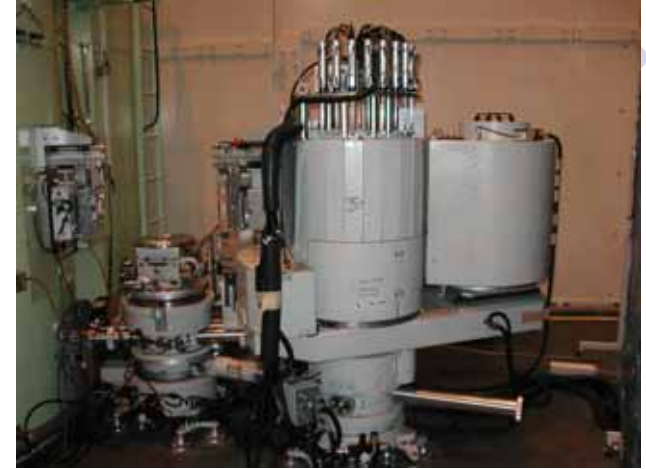
三軸分光器 TOPAN (理学研究科) 原子や磁気モーメントの運動・ゆらぎの観測 (高温超伝導、誘電体、強相関係)
