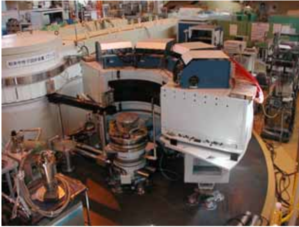
粉末回折装置 HERMES (金研) 結晶構造、磁気構造解析 (希土類、3d酸化物、強相関係)
